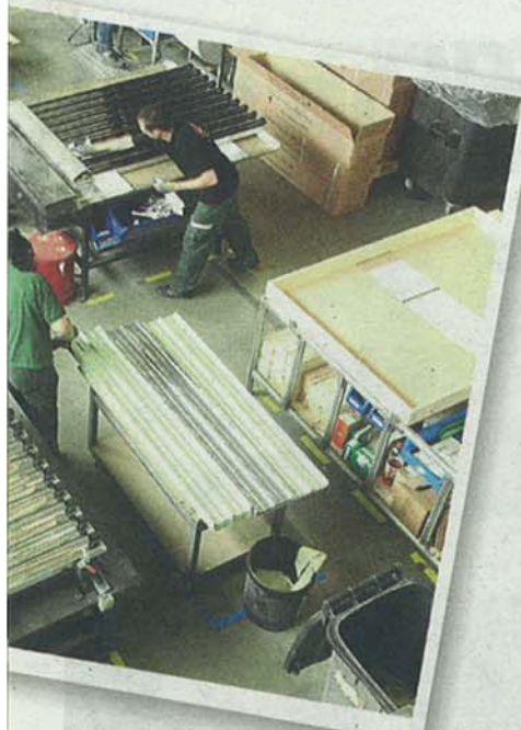
Fertigstellung der neuen Zehn-Quadratmeter-Kollektoren im Industriepark St. Veit
